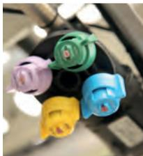
**Automatische Düsenwahl bei 7 bis 20 km/h mit MULTISPRAY DUO**
