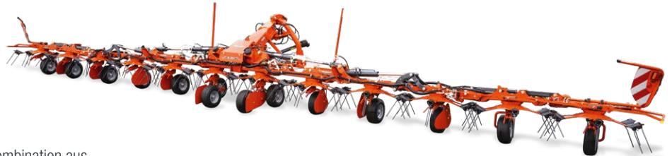
Der Giroheuer GF 13003 ist die optimale Kombination aus Kompaktheit und großer Arbeitsbreite. Dank der kompakten Konstruktion und dem geringen Kraftbedarf kann dieser Giroheuer an Traktoren der mittleren Leistungsklasse angebaut werden.
