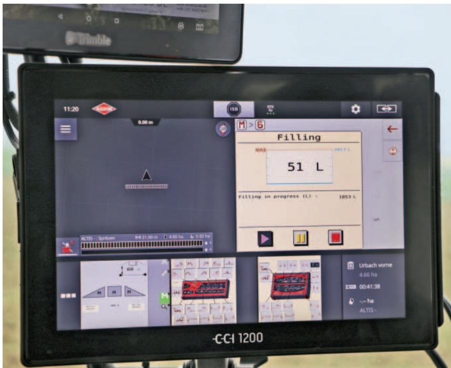
Alle Tasten und Schalter der Bedienterminals lassen sich individuell über ISOBUS belegen. Präziser Pflanzenschutz fängt mit der genauen Füllmenge dank automatischem Füllstop an.
