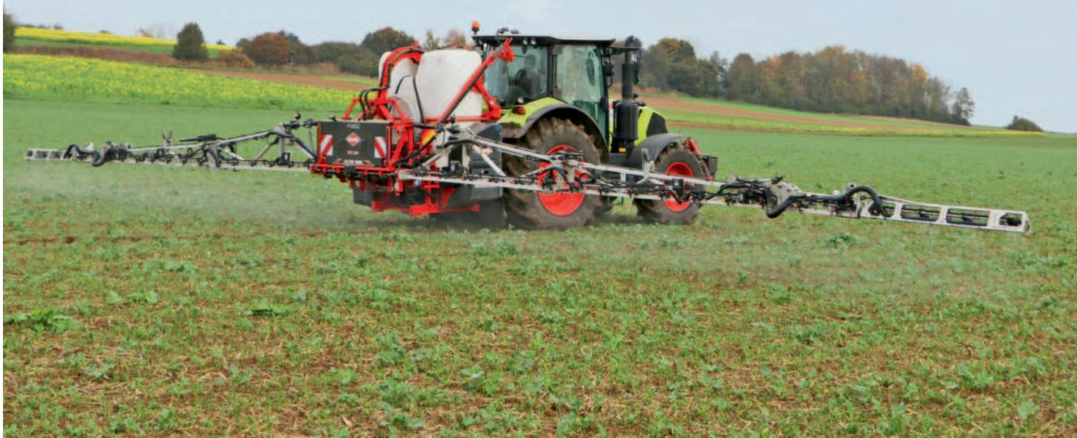
Durch die Pulsweitenmodulation bleiben Druck und Tröpfchengröße bei unterschiedlichen Geschwindigkeiten konstant.
