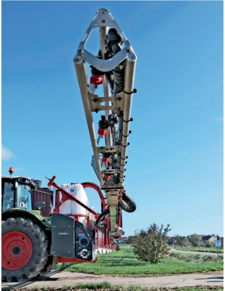
Alle Düsen sind durch das Gestänge geschützt. Es hängt in einer Parallelogrammaufhängung.
