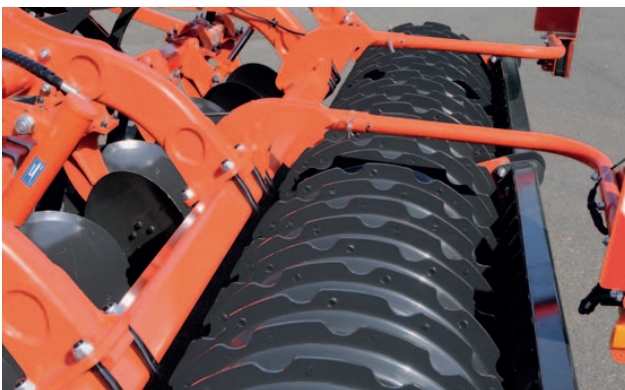
Bild 6: Walze des Cultimers mit 34 Scheiben
