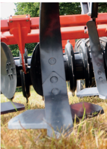
Bild 3: Standardzinken (80 mm) mit montierten Flügeln (350 mm)
