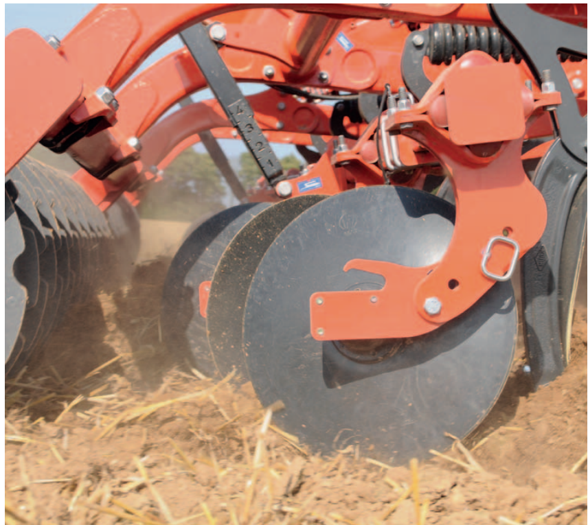
Bild 5: Einebnungsscheiben mit Einstellspindeln
