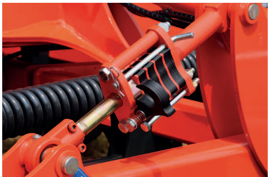
Bild 4: Klappbare Distanzscheiben zur Einstellung der Arbeitstiefe am Nachläufer
