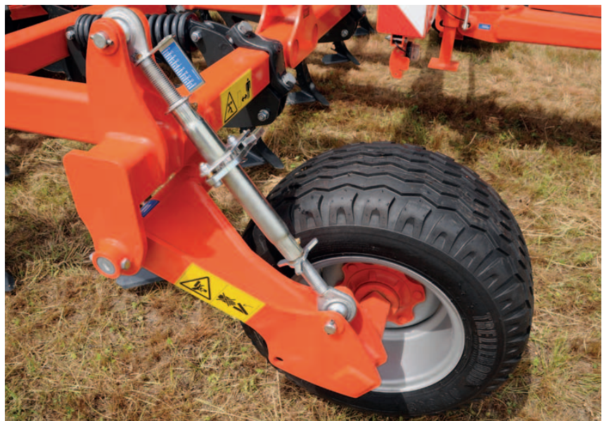
Bild 2: Manuelle Verstellung der Arbeitstiefe über eine Spindel an den Stützrädern
